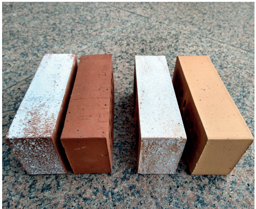
Mineralhaltige Natursteinklinker aus Natursteinmehl in Backsteinform
